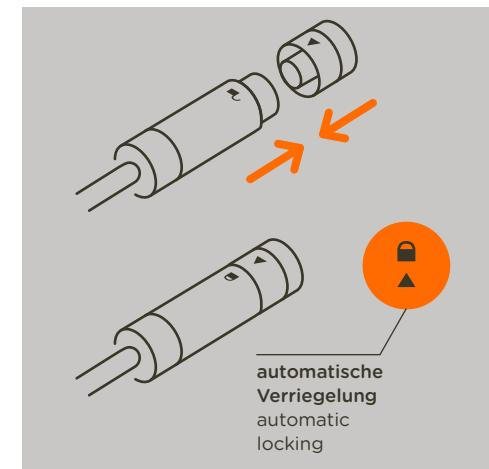
Im Außenbereich kommt es mehr als anderswo auf solide Verbindungen an, denen Wind und Wetter nichts anhaben können. Unser robustes TWISTLOCK-System kombiniert diese Hart-im-Nehmen-Qualitäten mit einem kinderleichten Stecksystem, das beim Verriegeln gleich Rückmeldung über die korrekte Endstellung gibt und somit Verlegefehler vermeidet.
