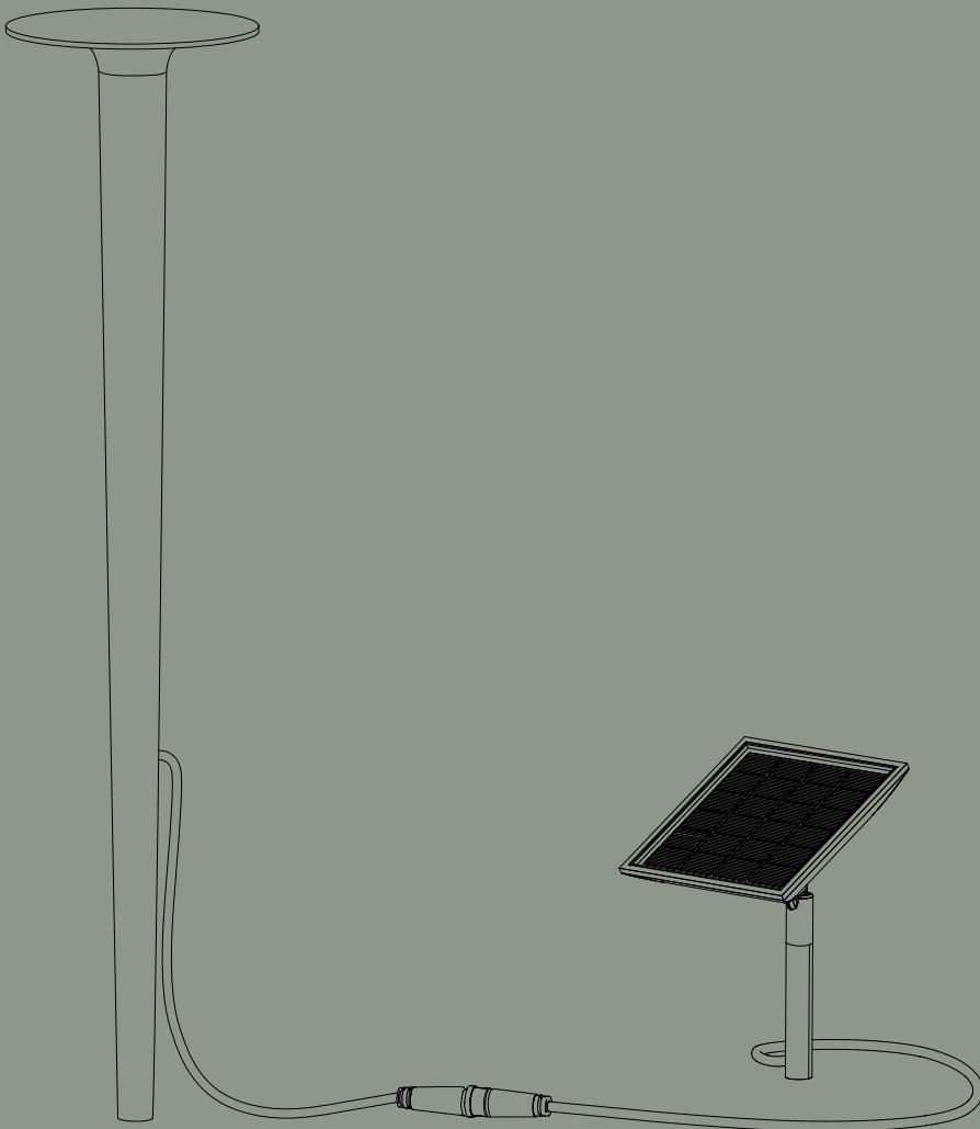
Die schlanke Schwester unseres portablen Bestsellers lix. Und genau wie diese ein Lieferant blendfreien, flächigen Rundumlichts, das atmosphärische Lichtinseln schafft. Die lix spike solar wird mit ihrem eigenen Solar- und Speichermodul versorgt und ist dadurch absolut autark.
